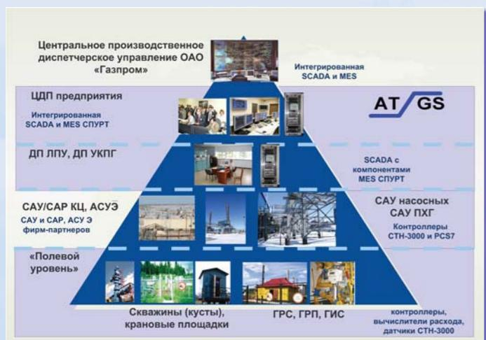
Компоненты многоуровневой интегрированной системы управления предприятием с выделением решений АТГС на базе СПУРТ и СТН-3000
