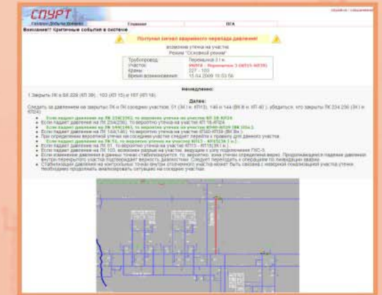
СППР: рекомендации по действиям диспетчера при срабатывании сигнальной системы (авария симулирована в ходе испытаний)
